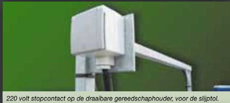
220 volt stopcontact op de draaibare gereedschaphouder, voor de slijptol.
