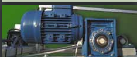
380 volt motoren met wormwielvertraging voorzien van levensduursmering.
